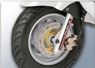
190mm大径ディスクブレーキ 安定した走安性と確実な制動力を発揮する190mm大径ディスクブレーキ
