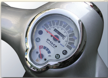
ティアドロップ型スピードメーター オシャレな雰囲気を出すティアドロップメータは燃料計も装備
