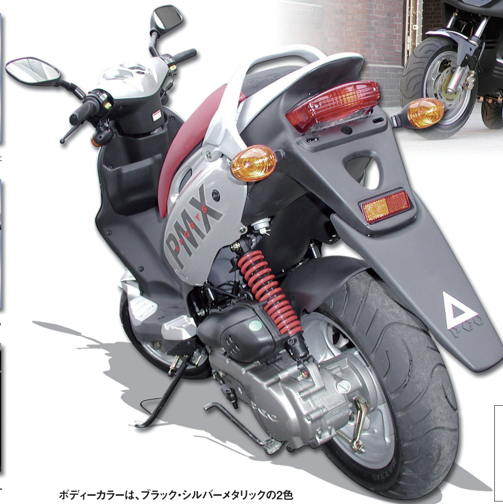
エンジン ラリーで培った技術を惜しみなく投入した2ストローク110ccエンジン。9.3PSを発揮するハイパワー。
