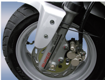
足廻り エンジンパワーを受け止める足廻りには、12インチアルミホイールと190mm大径ディスクブレーキを装備。
