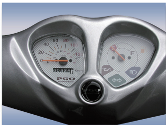
メーター 視認性向上の為、左にスピードメーター、右に燃料計とインジケータランプを配置したダブルメーター。
