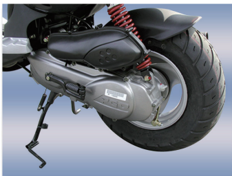
エンジン ラリーで培った技術を惜しみなく投入した2ストローク110ccエンジン。9.3PSを発揮するハイパワー。
